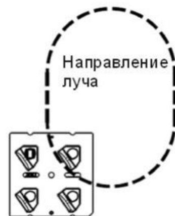
Рис. 10. Направление луча относительно конструкции линзы Strada 2x2 PX
