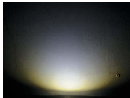
Рис. 1. Пример светового пятна nonpoint-светодиода с высокой неравномерностью цветности
