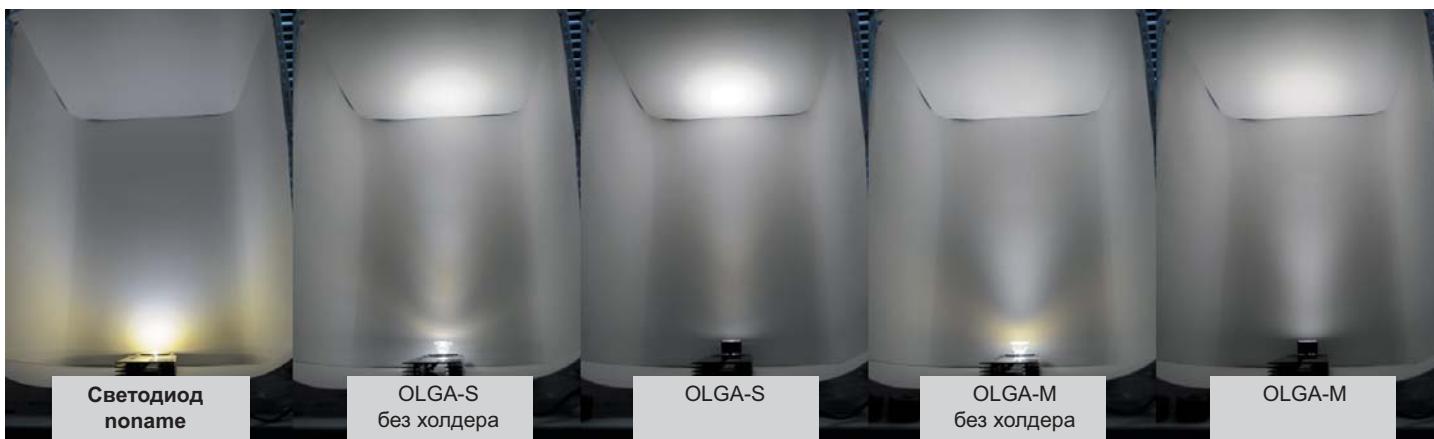
Рис. 6. Линза с холдером может помочь «спрятать» желтые пятна
