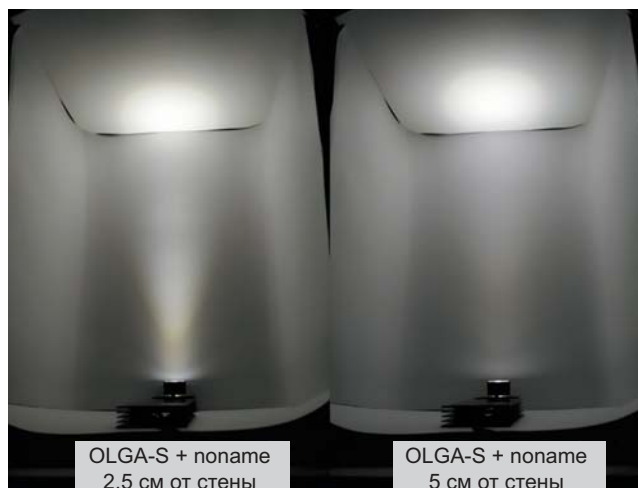
Рис. 7. Сглаживание цветовой неравномерности при удалении источника света от стены
