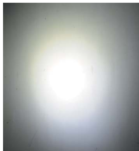
Рис. 2. Цветовая неравномерность в пятне nonpoint-светодиода с линзой
