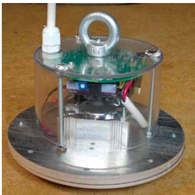
Рис. 11. Блок питания на 50 Вт в оболочке светильника
