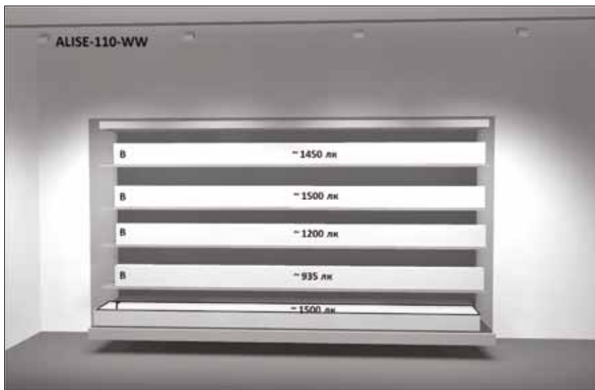
Рис. 4. Освещение стеллажа. Результаты расчета освещенности на вертикальных (В) и горизонтальных (Г) поверхностях товаров на полках
