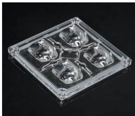
Рис. 6. Внешний вид линзы CS14632_STRADA-2X2MX-DWC с Ш-образной КСС
