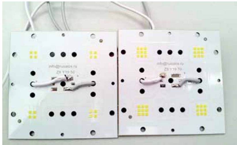
Рис. 1. Матрица из светодиодов Flip-Chip Seoul Z8Y1x для производства светодиодных модулей
