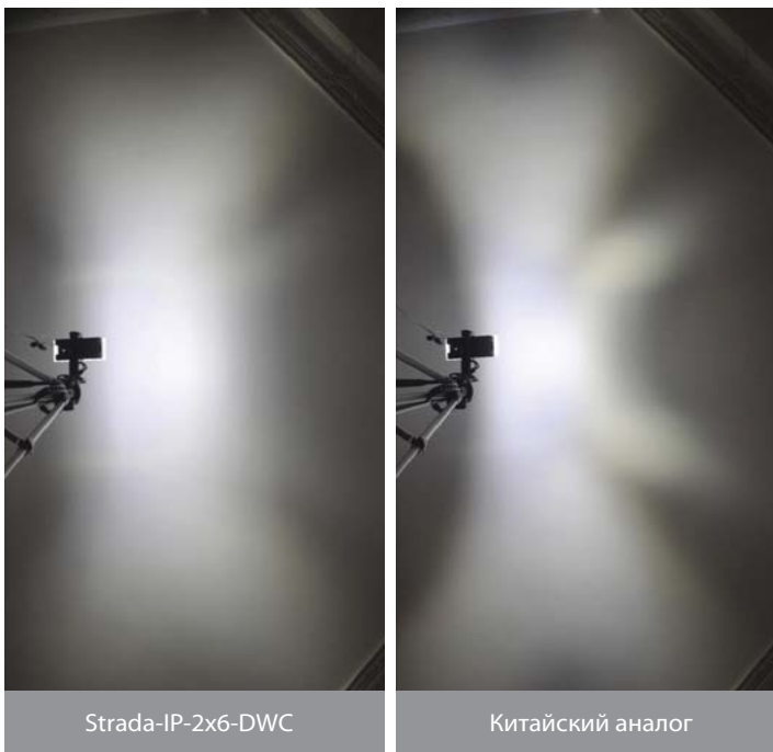
Рис. 4. Линза Strada-IP-2×6-DWC и китайский аналог с одним светодиодом
