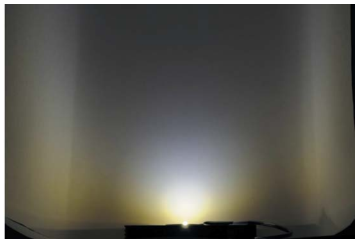
Рис. 2. Пример светового пятна светодиода Noname с угловой неравномерностью распределения цветов
